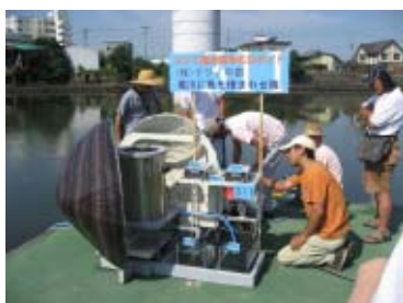
311 シジミ型水質浄化ロボット
