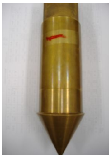
写真 1 高感度コーン貫入試験機 写真 2 試験中の様子
