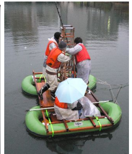
写真 1 高感度コーン貫入試験機 写真 2 試験中の様子
